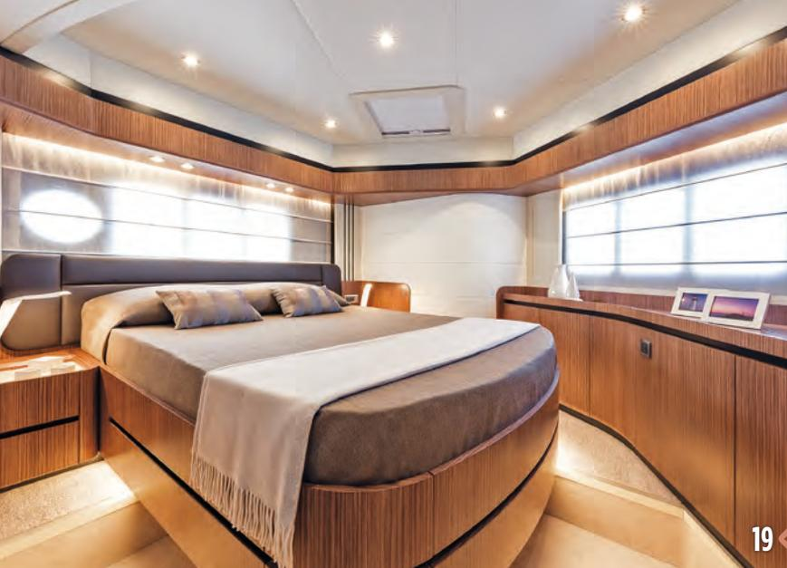
**19.** La cabina VIP, a proa, se ha dispuesto con el cabezal a una amura para colocar un mueble tocador en el lado opuesto.
