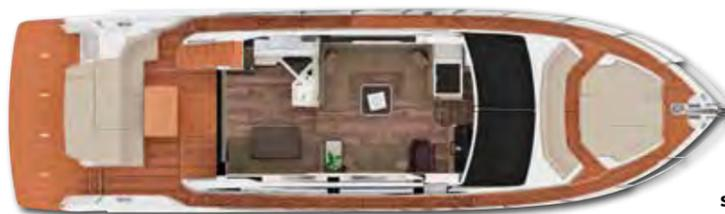
On distingue deux zones bien délimitées sous la timonerie : le coin repas à l'entrée, au contact du cockpit, et le salon avec ses sofas en vis-à-vis.
