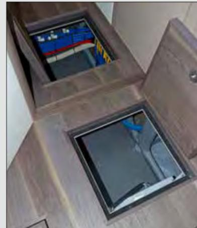
Sous la table du cockpit, un emplacement peut recevoir jusqu'à six défenses de belles dimensions.
