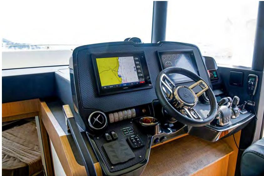
**La plancia di comando interna è decisamente grande,** ospita due maxi display ed una strumentazione molto completa. Le manette elettroniche ed il joystick di manovra sono posti sulla dritta, vicino all'immane portellone d'uscita, che Absolute yachts inserisce in tutte le sue imbarcazioni e che fa davvero la differenza nelle operazioni d'ormeggio .
