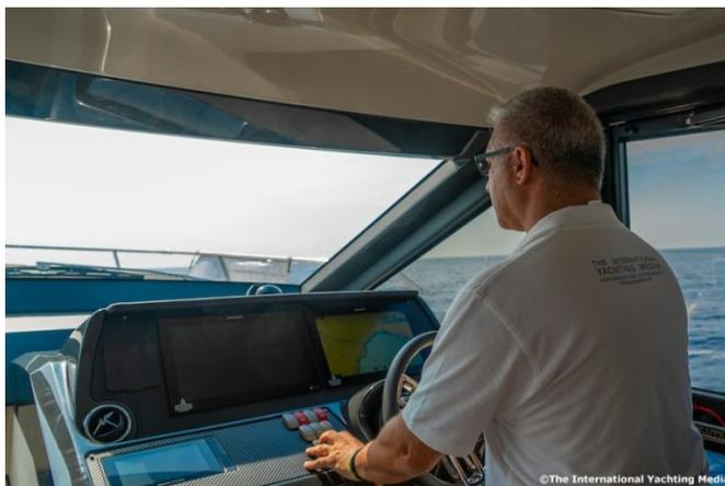
Nous accélérons encore un peu jusqu'à atteindre la vitesse de croisière, c'est-à-dire 22 nœuds à 3 400 tr/min avec une consommation totale de 7 litres par mille. Pas mal, surtout si l'on pense que la consommation en litres/mille se réduit encore à mesure que la vitesse augmente.
