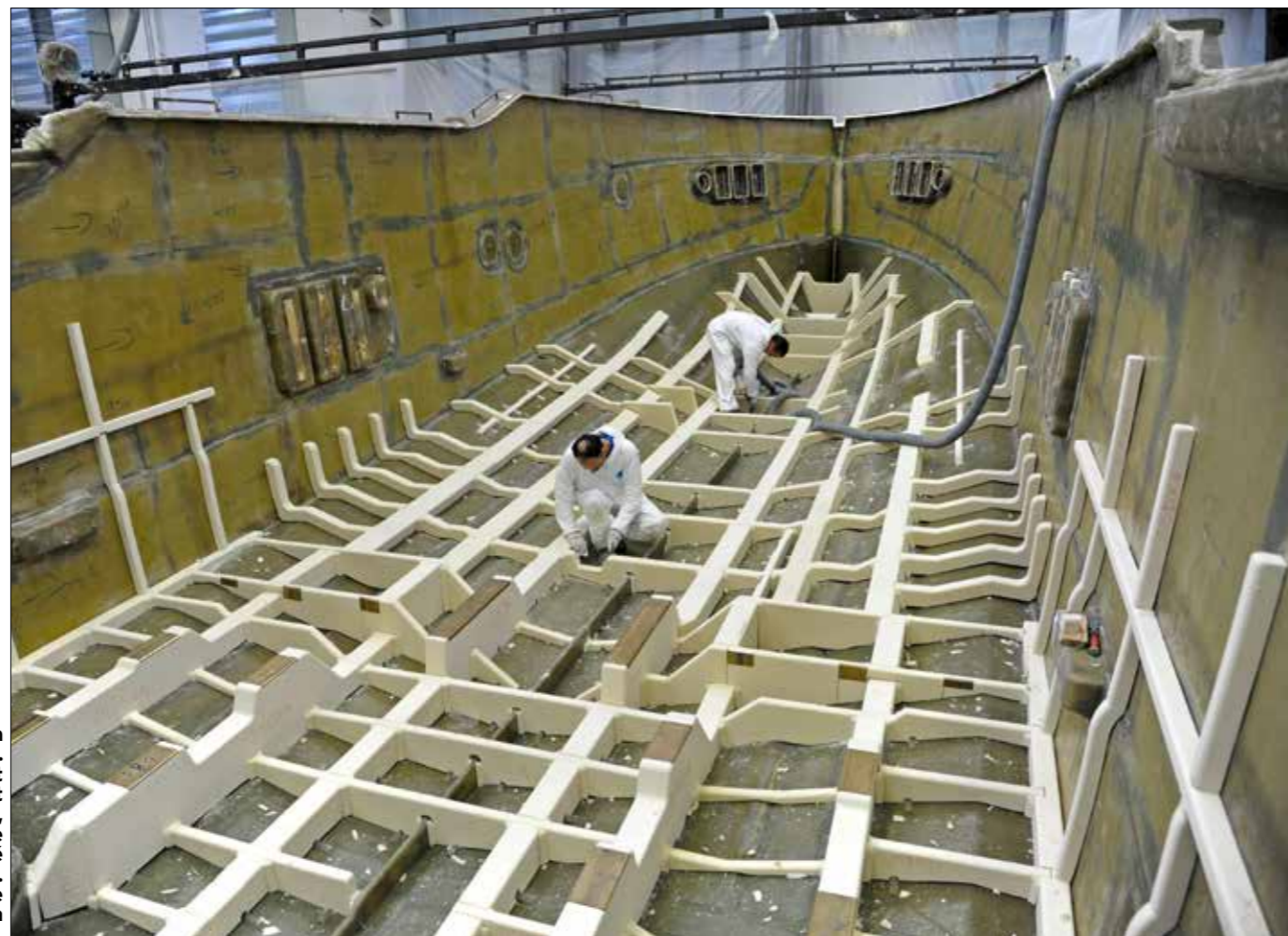
La coque est en partie moulée. Elle reçoit maintenant son carlingage, dont on note la densité de la trame. Il sera ensuite stratifié à la coque.
