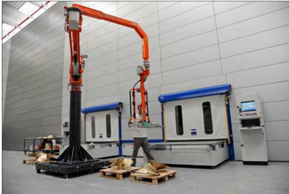
Les pièces nécessaires à la fabrication d'un bateau sont stockées dans une tour, dont on distingue l'entrée. Elles sont ensuite triées automatiquement et réparties dans les différents ateliers.
