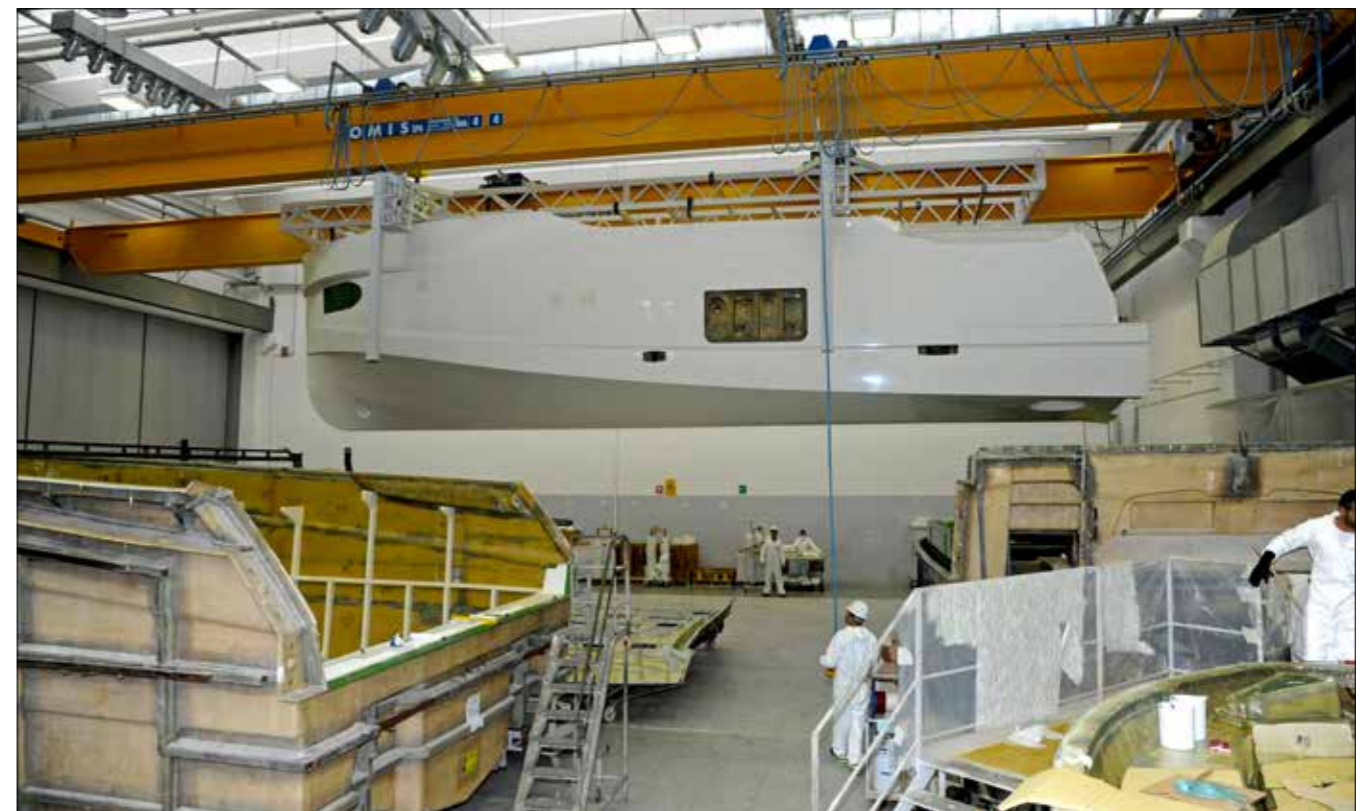
Aucune coque ne sort de son moule sans avoir préalablement reçu le module d'aménagement ISS, mais il reste encore beaucoup à faire.
