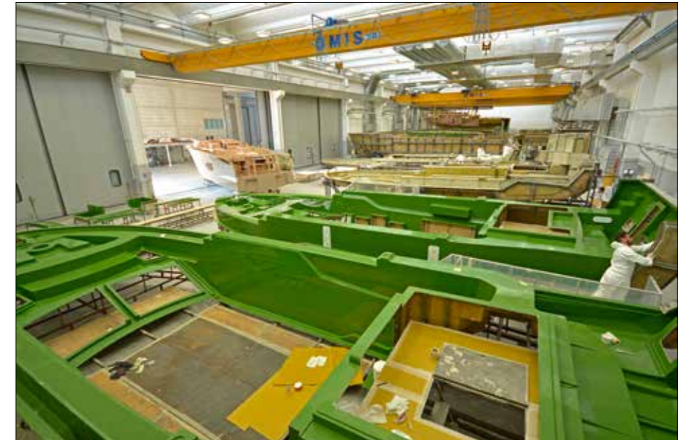
Le hall de moulage compte vingt postes de stratification. Absolute a volontairement choisi de conserver la méthode traditionnelle par voie humide, la stratification manuelle.
