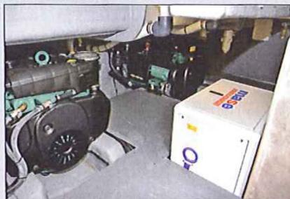
Die getestete Absolute 40 STL war mit zwei Volvo Penta D4-300 motorisiert. Mit den knapp 600 PS hat das Boot genügend Kraft und auch jederzeit noch etwas Reserven. Die Maximalgeschwindigkeit von 70 km/h ist beachtlich. Die Werft bietet auch eine Motorisierung mit zwei D6-330 an. Die 40 STL wird damit zwar nur unwesentlich schneller, hat aber in der Beschleunigungsphase mehr Dynamik. Ob das allerdings den Aufpreis Wert ist, sei dahin gestellt.
