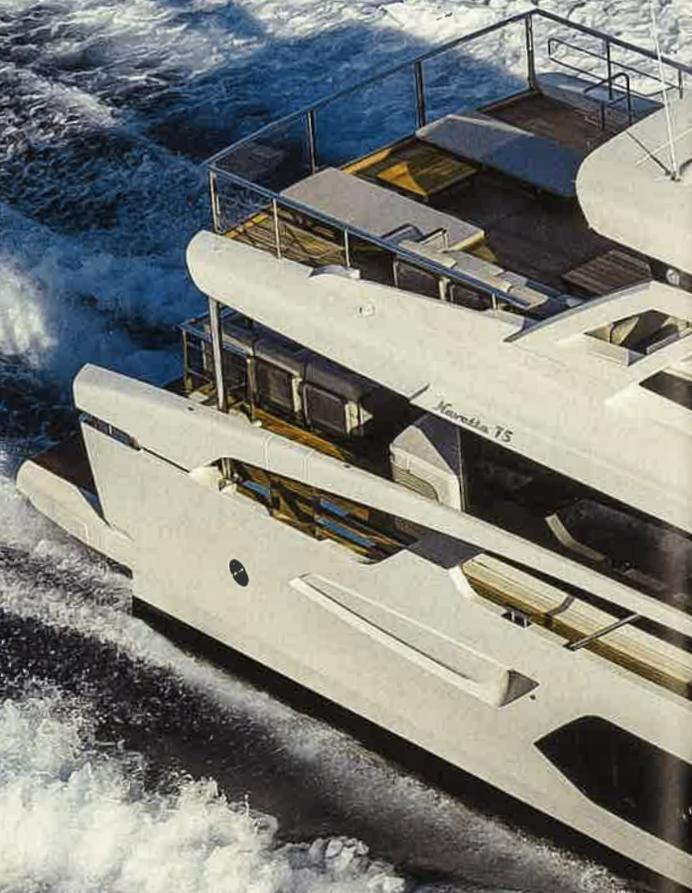
Volle Gleitfahrt: Die 23 Meter lange Navetta 75 übernahm den GFK-Rumpf von der 73. Das IPS-angetriebene Absolute-Flaggschiff schafft maximal 24 Knoten.
