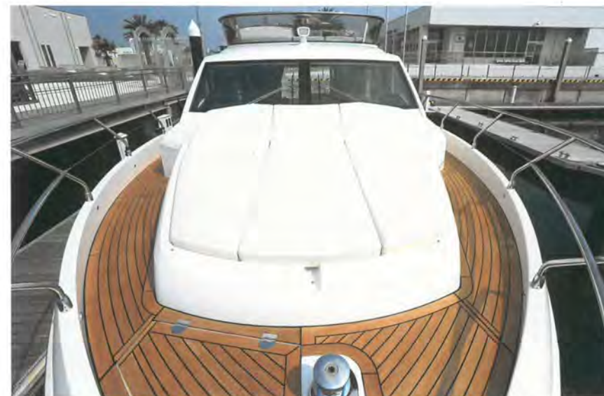
フォアデッキには、かなり大きなキャビンラングが突出しています。船首室の天井高が十分に確保されているのは、この造作の恩恵。大型のサンパッドが装備されています
