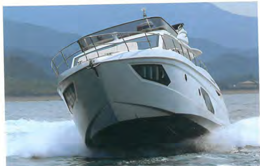
フレアのない船首は、居住性を重視したクルージングモデルらしいところ。それにより、船首室の壁面を垂直に近い角度にでき、より広々としたキャビンにできるわけです
