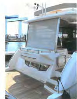
コクピットの後部には、フライブリッジのための支柱を利用して、ロールアップタイプのシェードが設けられています。太陽の方向によっては、きわめて有用な装備品です
