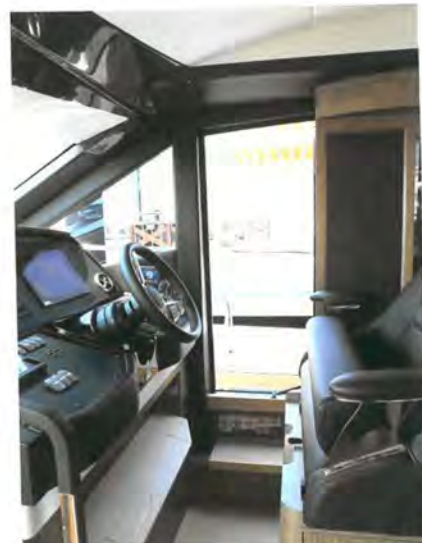
ロワーステーション。こちらにもドアが設けられています。サイドデッキからダッシュボードのジョイスティックを操作できるため、離着岸などに便利です
