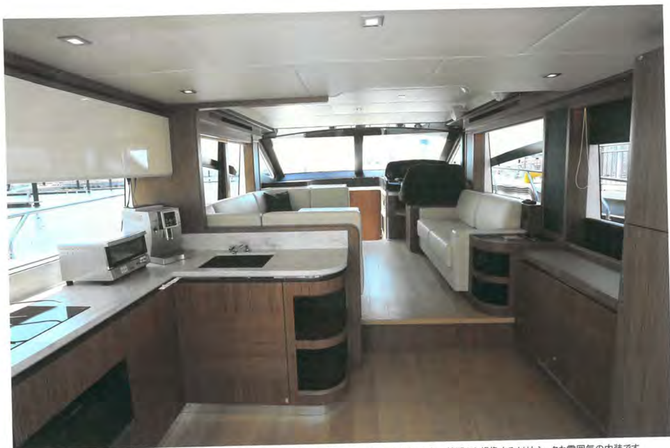
デッキハウス内はサロンエリアの床が一段高くなりますが、それでもサロン中央の天井高は1.95メートルあります。外観から想像するよりもシックな雰囲気の内装です
