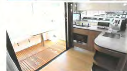
上：コクピット。船尾からのボーディングゲートは右舷のみ。コクピットシートのさらに後部には、サンパッドが設けられています。サンパッドの多いフネです 下：デッキハウスの最船尾側に設けられたギャレー。床レベルがコクピットと同じことに注目。スライディングドアも開口部が大きく取れる造りになっています
