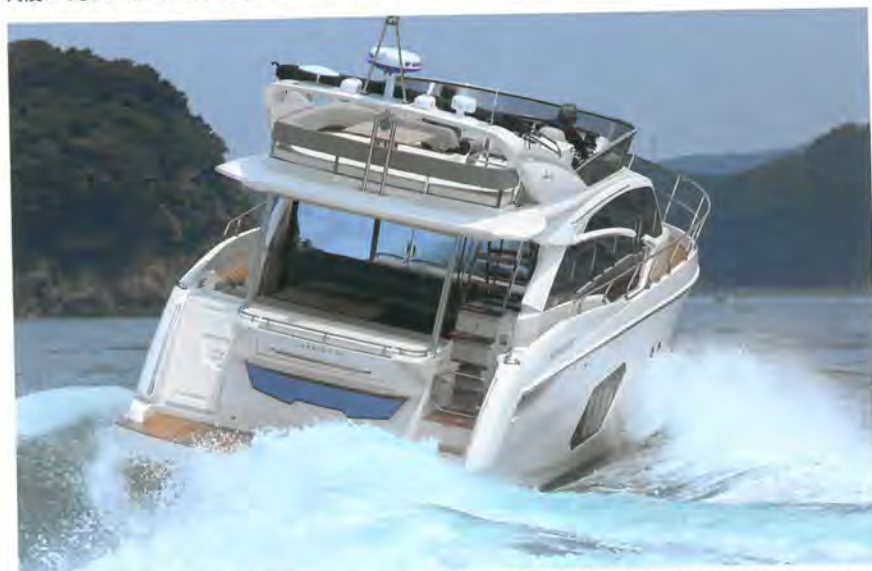
船尾近くにエンジンを置くIPSなので、トランサム部分の噴水は深く、どうしても曳き波が大きくなってしまいますが、それはやむを得ないところです
