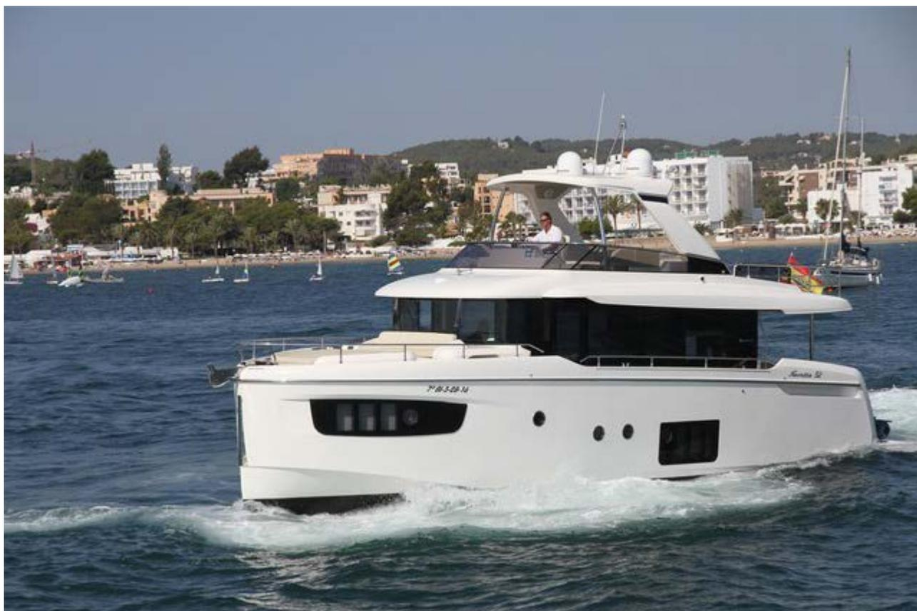
En mar abierto apreciamos que la potencia de los IPS600 de 435 Hp es la adecuada, ya que para una eslora de semidesplazamiento es inútil añadir más caballos. Sale en semiplaneo en solamente 9 segundos, y en 16 más se pone por encima de los 24 nudos: una marca muy buena. Una motorización que cumple con su cometido, ofreciendo un barco navegación marinera y silenciosa, ya que en el interior el nivel acústico no superó los 65 decibelios, prácticamente un récord en este tipo de barco.
