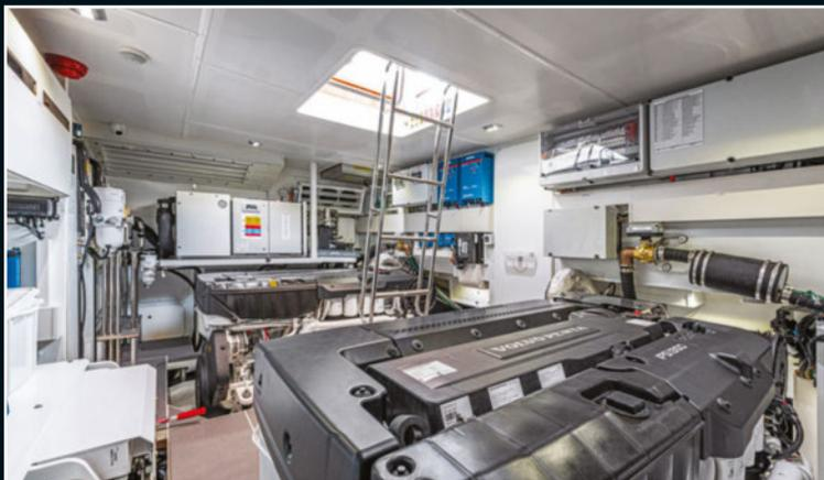
Très spacieuse, la salle des machines abrite les deux imposants blocs Volvo de 12,8 L. Près de l'échelle, une porte communique avec la cabine de marin.
