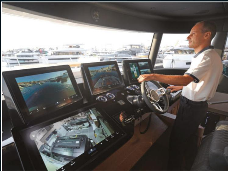
Le tableau de bord est identique à celui de la Navetta 68. Au port, pas moins de six caméras peuvent être branchées en simultané, sans compter la vue du dessus à 360° développée par Raymarine.
