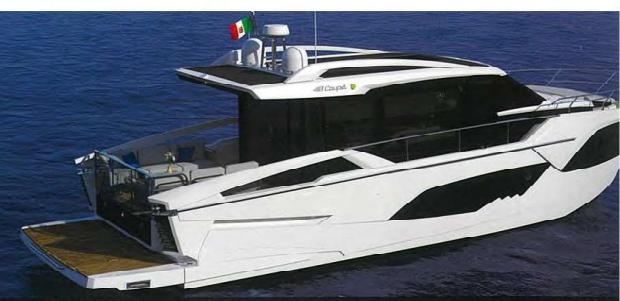
左:舷側船尾端は「カットオフテール(cut off tail)」スタイル。トランサム部分はガラス張り。これがアーリートの最新トレンドだ
