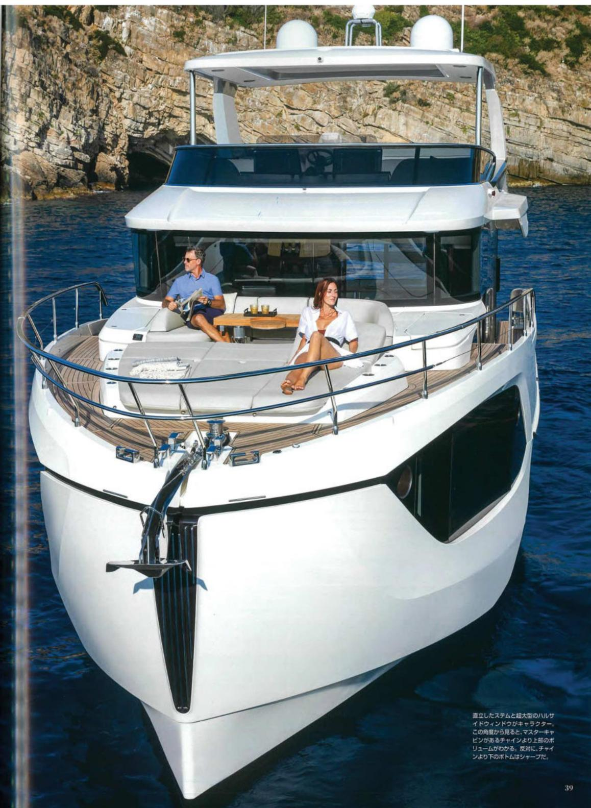
直立したステムと超大型のハルサイドウィンドウがキャラクター。この角度から見ると、マスターキャビンがあるチャインより上部のボリュームがわかる。反対に、チャインより下のボトムはシャープだ。
